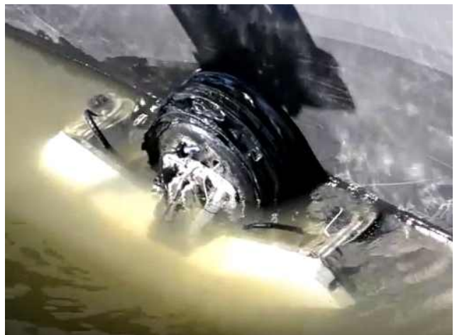
Fleet Cleaner의 선박 청소로봇 작업 모습 (좌: 수상, 우: 수중)
