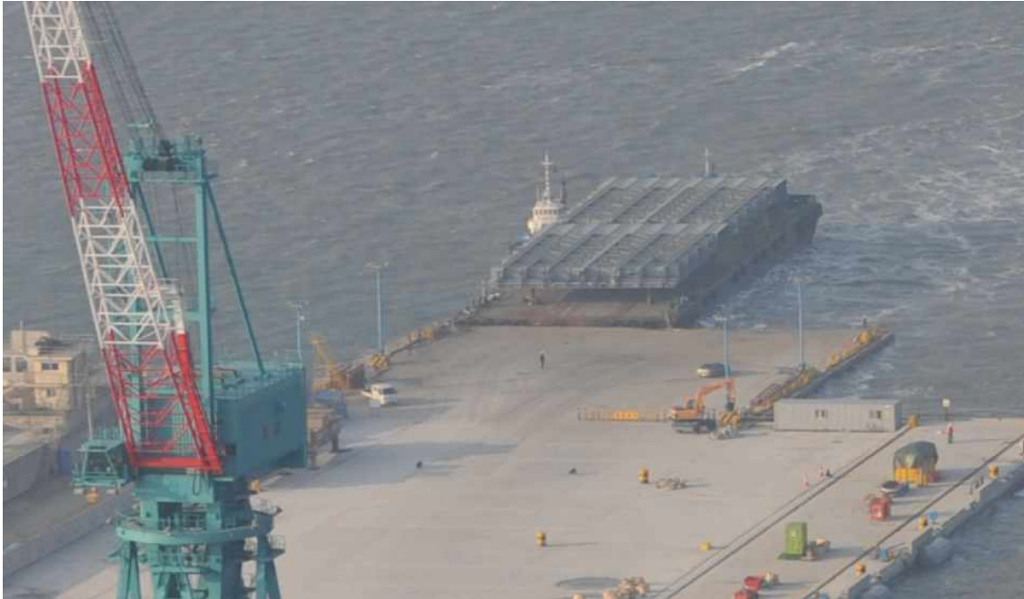
&lt;그림 V-2&gt; 현대중공업 물양장 내 조선블럭을 실은 바지선
