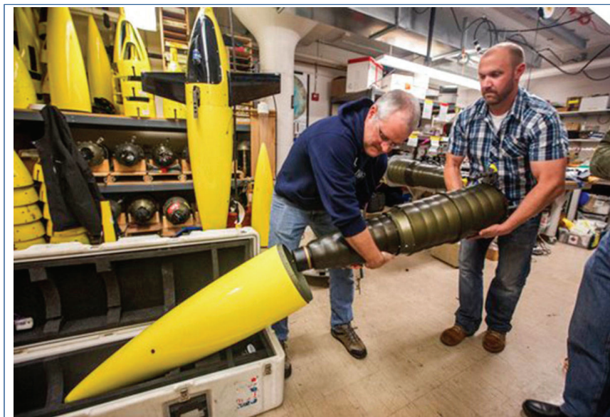
그림4. 워싱턴 대학교 연구진이 푸파를 씨글라이더에 장착하는 모습
