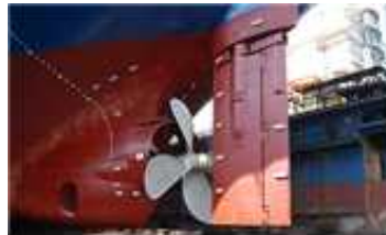
Mewis Duct 장착 (출처: Becker사)
