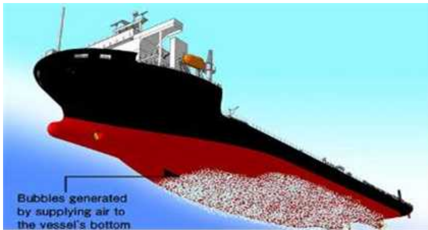
〈그림 4-6〉 Air Lubrication 시스템
