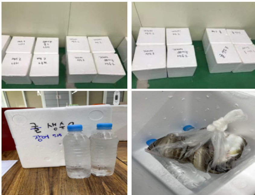
〈그림 4-4〉 신선식품 택배 배송용 젤 아이스팩 대체를 위한 적합성 실험
