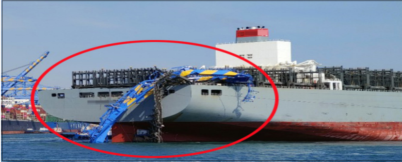
〈그림 3-7〉 부산항 신항 1부두 크레인과 선박 간 충돌 모습
