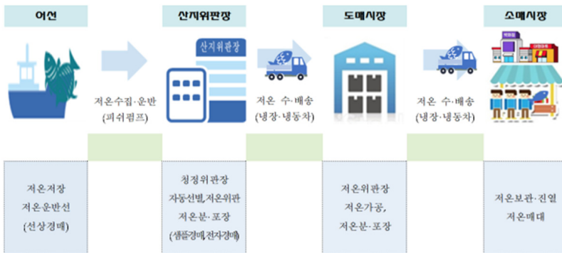
〈그림 5-3〉 수산물 저온유통시스템 체계도
