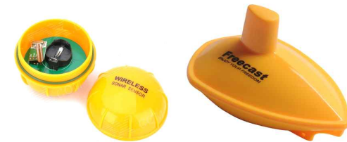
자료: Yachting Electronic co. Ltd( http://www.goyachting.cn ), 검색일 : 2015.11.11. | 그림 4-3 | 소나 센서 개발
