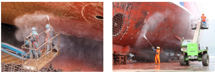
〈그림 2-4〉 선박을 입거한 후 방오도료와 부착생물을 제거하는 모습
