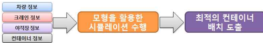
<그림 4-35> 컨테이너 배치 자동화 시스템 개요
