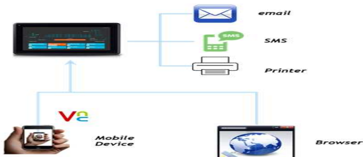
<그림 3-68> Alarm Handling System 143)
