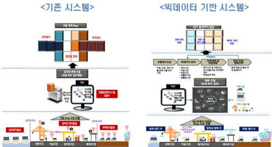
<그림 3-17> 빅데이터 기반 지능형 항만교통정보시스템 개념도
