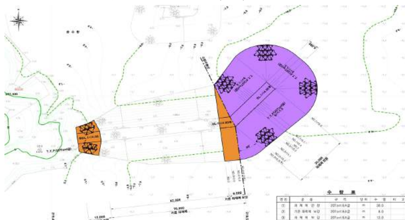
〈그림 4-2〉 ○○항 일원 파제제(TTP) 설치공사 계획평면도
