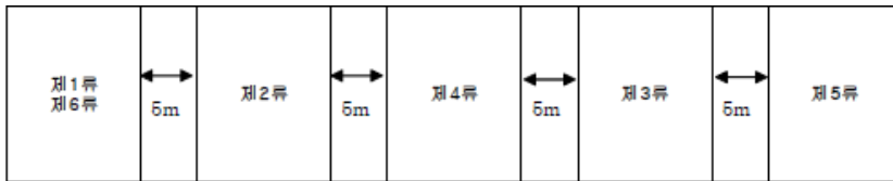
<그림 2-3> 옥외저장소의 위험물 컨테이너 종류별 이격거리
