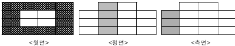
<그림 2-2> 옥외저장소의 위험물 컨테이너 적재방법
