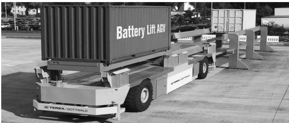
〈그림 2-8〉 RWG에서 사용하고 있는 Lift AGV
