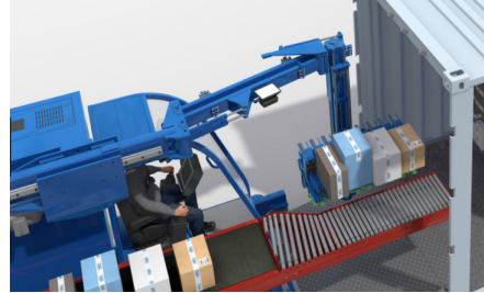
〈그림 5-10〉 화물 상하차 작업용 로봇 시스템
