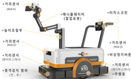
〈그림 5-9〉 모바일 매니퓰레이터 형태의 피킹/분배 작업용 로봇
