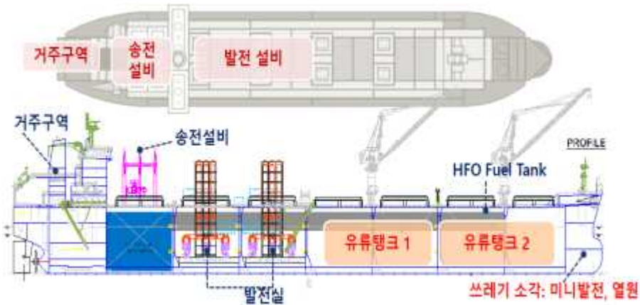
〈그림 4-12〉 중고 선박을 활용한 도서 지역 발전 설비 모델
