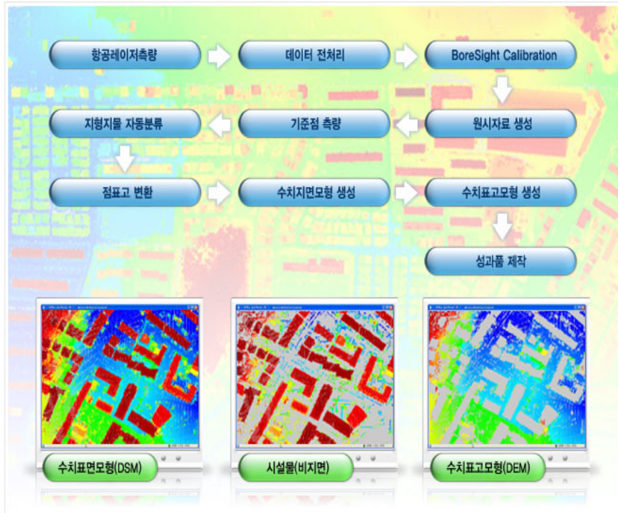
| 부록 그림 4 | 항공레이저 측량에 의한 수치표고모델 제작 절차
