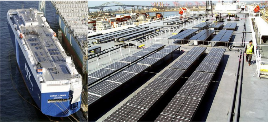
【그림 4-5】 자동차 운반선 ‘AURIGA LEDER’ (좌)와 그 위에 설치된 태양광 패널(우)
