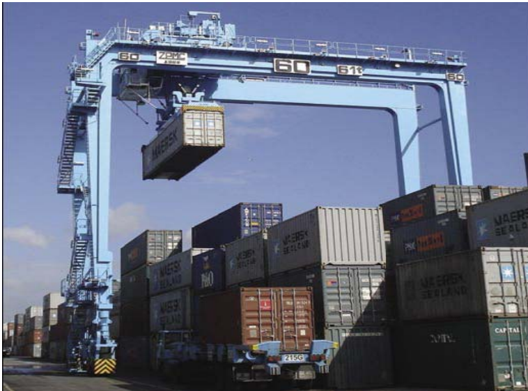
<그림 4-1> 스페인 알제시라스항의 ECO-RTG
