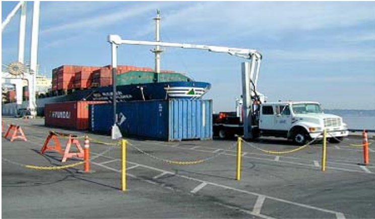
감마선을 이용한 이동식 검색기 VACIS
