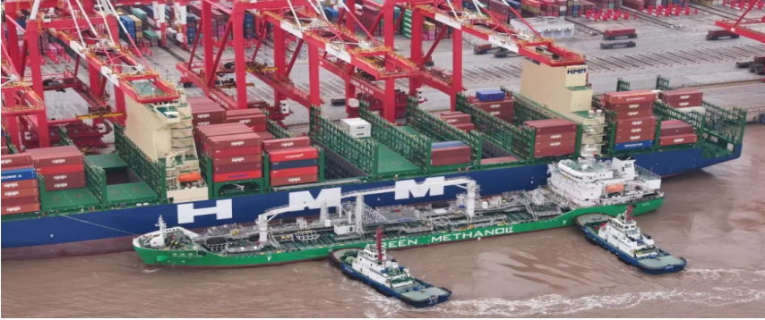
〈그림 3-5〉 HMM 그린호 메탄올 벙커링 연료 주입 모습
