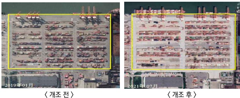
〈그림 3-3〉 샤먼항 하이룬 컨테이너터미널 개조 전후 야드 레이아웃
