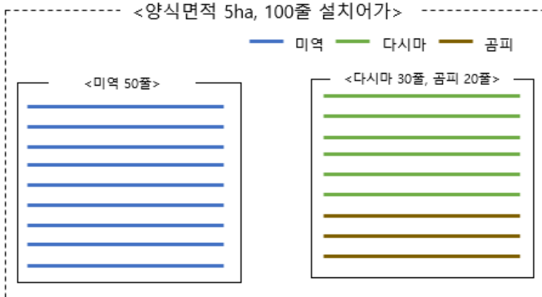
〈그림 3-1〉 전북 먹이용 해조류 시설 설치 방식
