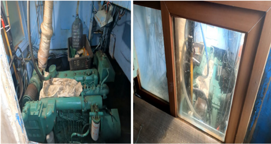
〈그림 6-4〉 울릉도 지역 일부 연안복합 어선의 기관실 격벽 불법개조 사례
