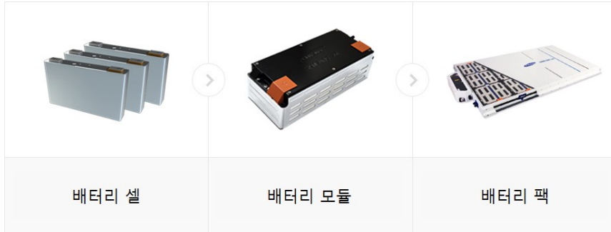
〈그림 3-2〉 배터리 조립 순서
