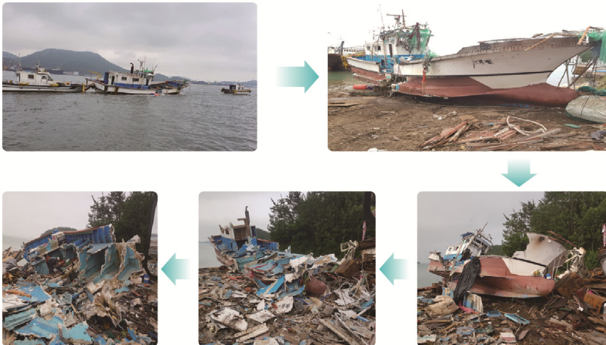
〈그림 3-2〉 FRP 폐어선 인양 및 해체 작업 과정
