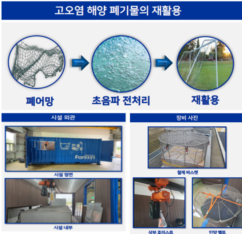
〈그림 4-15〉 포어시스의 폐어구 초음파 전처리 체계
