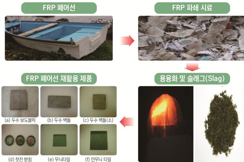
〈그림 4-13〉 FRP 폐어선을 재활용한 슬래그 원료 생산
